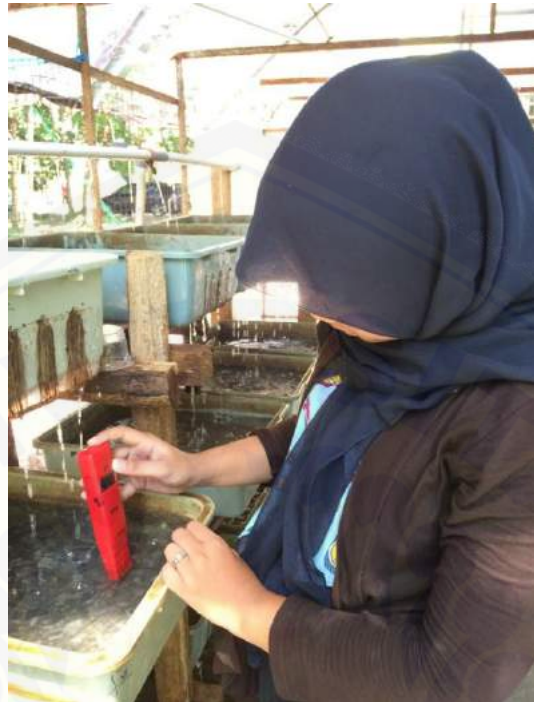
Gambar J6. Pengukuran pH dalam media
