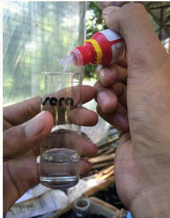
Gambar J7. Pengukuran kadar ammonia
