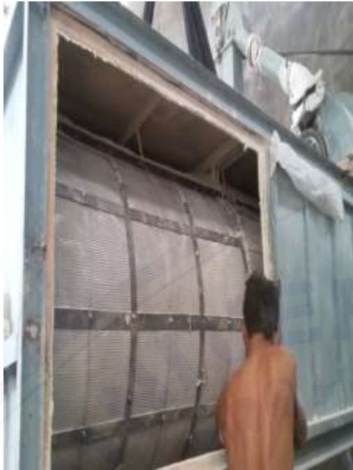
Gambar 5. Bagian Mesin Ayakan Tepung Ubi Kayu
