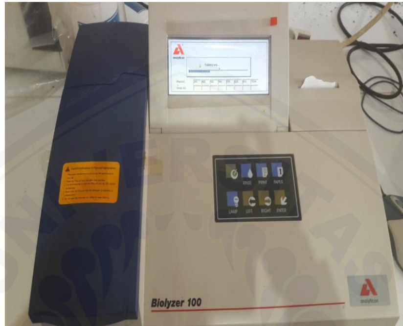
Gambar 3. Biolyzer 100 merupakan alat yang digunakan untuk mengukur kadar kolesterol total mencit
