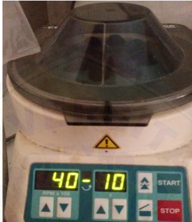
Gambar 9. Proses sentrifuge darah menciit agar homogen dan membentuk 2 lapisan darah yaitu endapan dan serum
