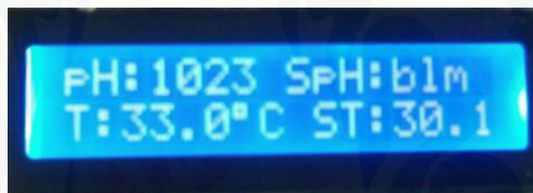
Gambar 2.6 Liquid Cristal Display (LCD)
