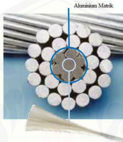
Gambar 2.5 Penampang penghantar ACCR dengan inti Al-Matrik komposit dikelilingi serat Al-Zr (3M, 2014)
