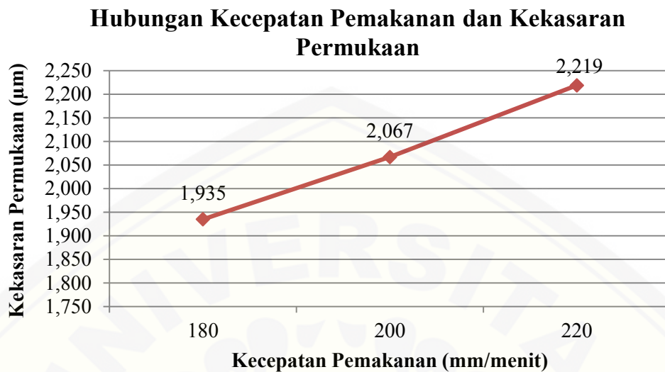
Gambar 4.2 Hubungan kecepatan pemakanan dan kekasaran permukaan
