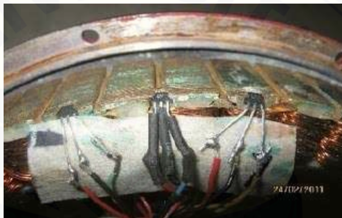
Gambar 2.10 Penempatan sensor hall pada stator ( http://electricisart.blogspot.com )
