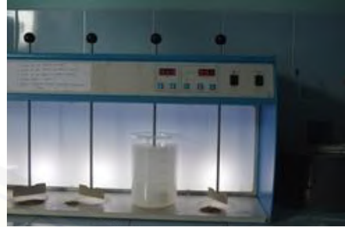
Gambar 8. Aduk larutan menggunakan jar test dengan Kecepatan 40 RPM Selama 3 Menit (pengadukan lambat)
