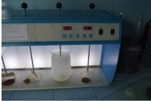
Gambar 7. Aduk larutan menggunakan jar test dengan Kecepatan 140 RPM Selama 15 Menit (pengadukan Cepat)
