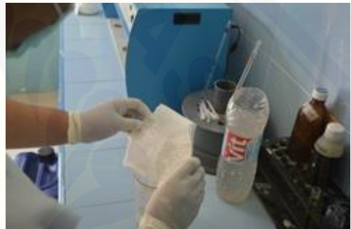
Gambar 2. Masukkan Tawas Pada Beaker Glass
