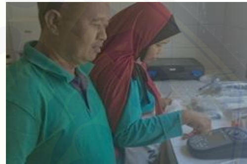
Gambar 10. Pengukuran Kadar Fluor Menggunakan Alat Spektrofotometer, dalam pengoperasian dibantu oleh staf LABKESDA SITUBONDO
