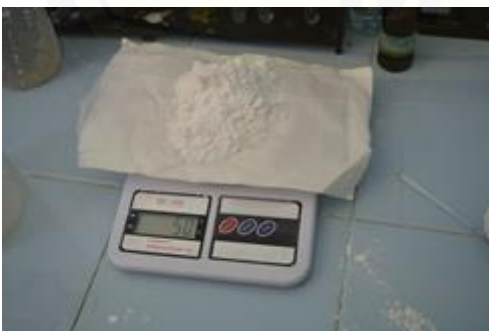
Gambar 1. Timbang Kapur Menggunakan Timbangan Digital
