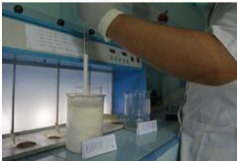
Gambar 5. Ambil larutan Kapur dan Tawas Menggunakan Pipet Ukur
