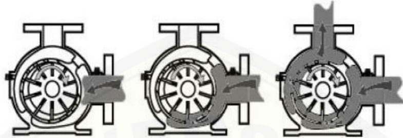
Gambar 2.19. Ilustrasi kerja pompa sentrifugal tipe radial
