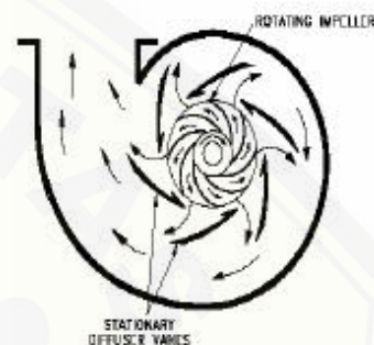
Gambar 2.17. Pompa rumah diffuser tipe radial (Sumber : Chuch :1996)
