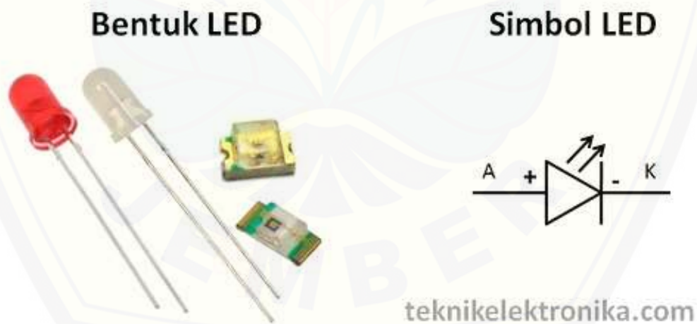
Gambar 2.7 bentuk dan simbol led
