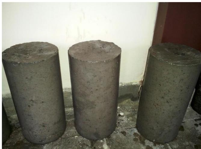
Gambar 3. Benda Uji SCC dengan PET 5%
