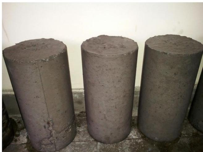
Gambar 4. Benda Uji SCC dengan PET 10%
