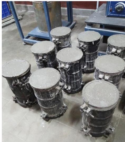
Gambar 1. Pencetakan Benda Uji
