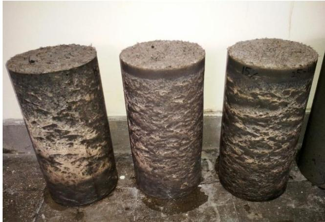
Gambar 2. Benda Uji SCC dengan PET 0%
