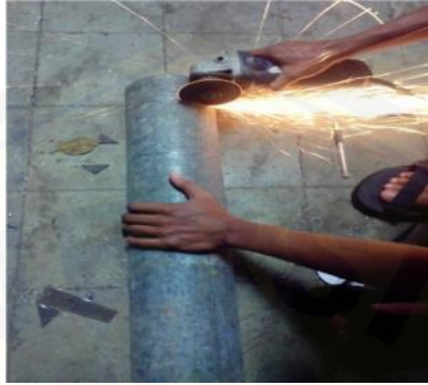
C.1 Pemotongan untuk rumah hopper
