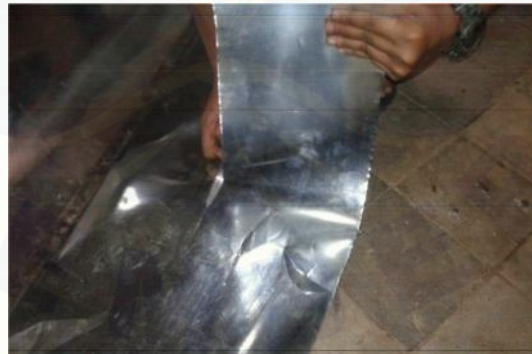
Gambar C.11 Pematongan hopper keluar
