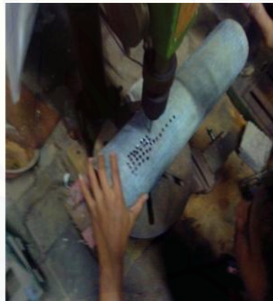
Gambar C.2 Pengeboran untuk membuat sarangan
