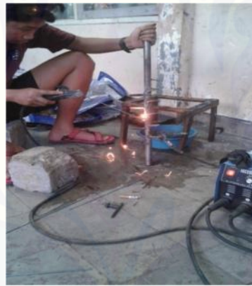
Gambar C.8 Penyambungan pisau dengan las
