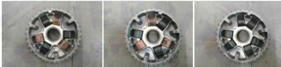
Gambar 3.1 Metode Penempatan Roller Kombinasi
