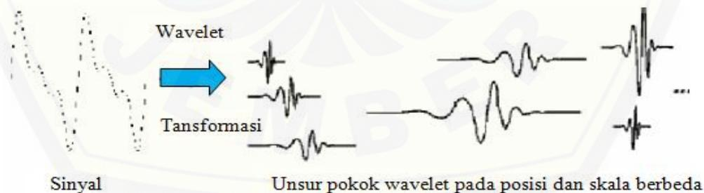
Gambar 2.14 Ilustrasi transformasi dengan transformasi *wavelet* kontinyu yang menghasilkan komponen *wavelet* dari skala dan posisi (Sumber : Helbert, 2007)
