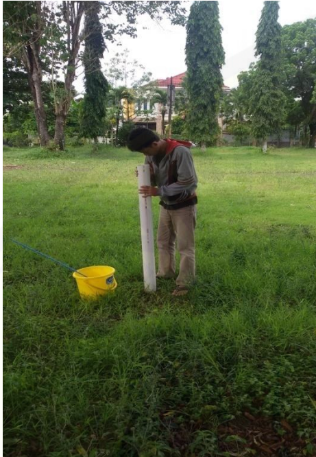
Pemasangan alat uji permeabilitas
