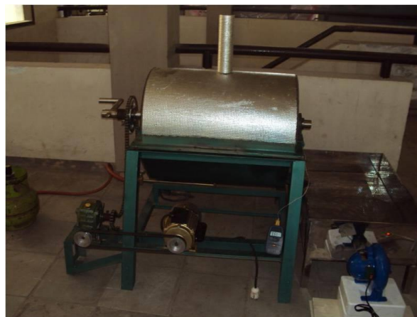
Gambar 5.2 Mesin penyangrai kopi tipe rotari
