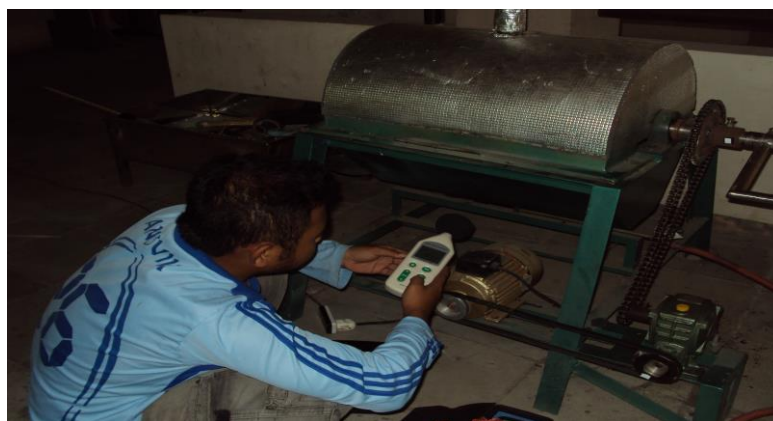
Gambar 5.12 Pengukuran tingkat kebisingan mesin sangrai kopi tipe silinder horizontal.
