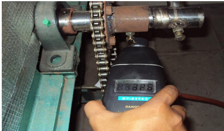
Gambar 5.11 Pengukuran putaran silinder sangrai
