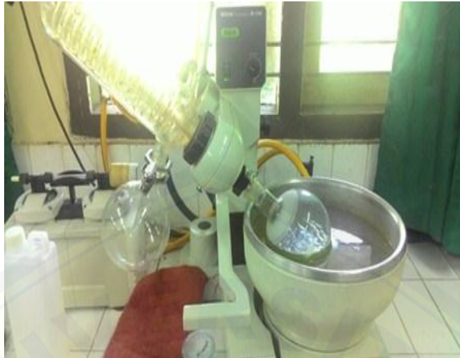
Gambar 3. Proses esktraksi bahan tanaman dengan rotary evaporator .
