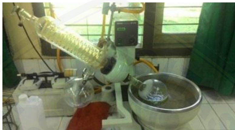
Gambar 3.3 Ekstraksi Bahan Tanaman Menggunakan Rotary Evaporator
