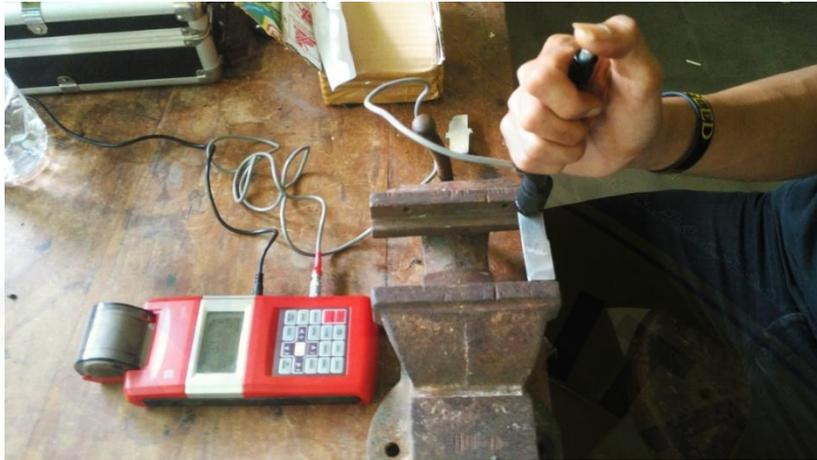
Saat melakukan pengujian kekerasan di Laboratorium Material Teknik Mesin, Universitas Jember
