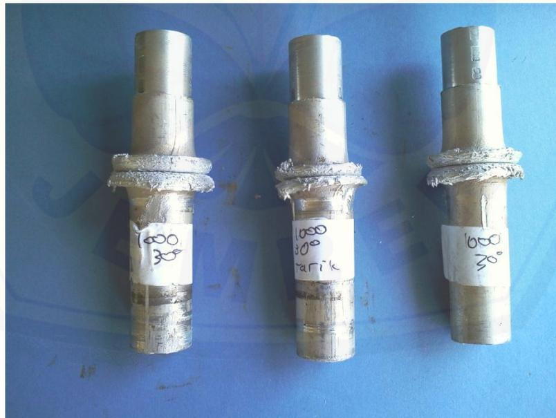
D. Spesimen yang sudah siap dilakukan uji tarik
