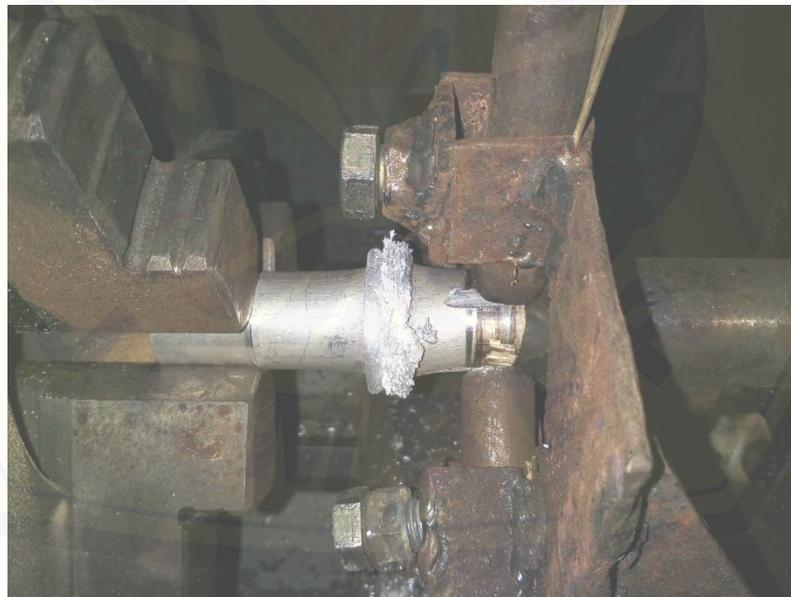
C. Hasil pengelasan *friction welding* Al 6061
