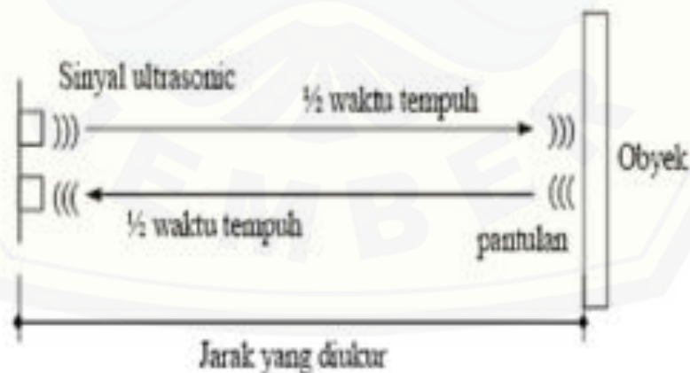
Gambar 2.4 Cara Kerja sensor Ultrasonik (Sumber: Hendra Hermawan, 2011)
