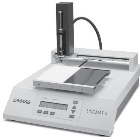
Gambar 2.24 Camag Linomat 5 untuk aplikasi larutan sampel pada lempeng KLT. Alat ini menggunakan teknik penyemprotan yang memungkinkan penotolan dengan volume sampel yang lebih besar pada larutan dengan konsentrasi rendah dibandingkan penotolan kontak langsung. Sampel terkonsentrasi dalam bentuk pita sempit dengan panjang sesuai yang diinginkan. Untuk tujuan preparatif, larutan sampel dapat diaplikasikan sebagai pita sempit yang panjang sepanjang lebar lempeng KLT
