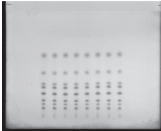
Gambar 4.6 Pemisahan kortikosteroid pada silika gel 60 Lempen sorben : KLTKT silika gel 60 F254 kaca (Merck) Fase gerak : kloroform/metanol (93 + 7 v/v) Deteksi : 0,5% w/v tetrazolium biru dalam metanol Zona : 1, prednisolon; 2, hidrokortison; 3, prednison; 4, kortison; 5, kortikosteron; 6, kortexolon; 7, 11-dehidrokortikosteron; 8, 11-desoksikortikosteron (dari R_f terendah) Konsentrasi : 20 ng per zat
