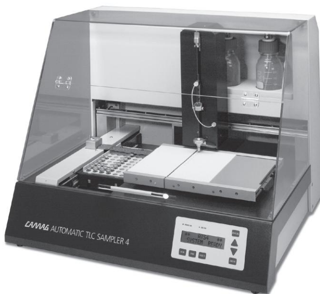
Gambar 2.25 Camag Otomatis KLT Sampelr (ATS) 4 untuk aplikasi noda dan pita dari larutan sampel dalam vial. Pengoperasiannya diprogram dan dikendalikan oleh komputer. Kisaran Volume yang dianjurkan per sampel 100-5000 nl untuk noda dan 2-20 \mu l untuk pita.
