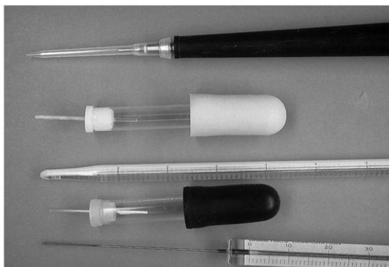
Gambar 2.22 Peralatan aplikasi sampel secara manual 1. Pipet Eppendorf dengan syringe 10 \mu\text{l} 2. Microcapillary 5 \mu\text{l} dengan holder 3. Pipet aplikasi (50 \mu\text{l} ) 4. Microcapillary 1- \mu\text{l} dengan holder 5. Unimetric syringe (50 \mu\text{l} )
