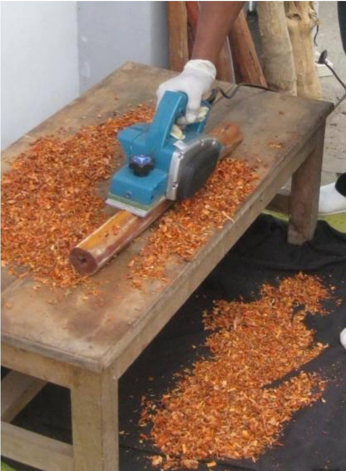
Gambar 9. Proses penyerutan (elektrik) bahan simplisia kayu
