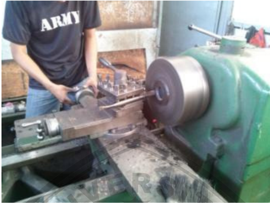
Gambar 17. Proses pembuatan alat blow molding plastik
