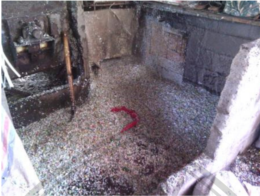
Gambar 9. Observasi hancuran chip sampah plastik hasil proses penghancuran sampah plastik pada alat penghancur
