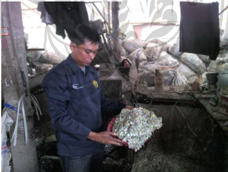
Gambar 10. Observasi hancuran chip sampah plastik hasil proses penghancuran sampah plastik pada alat penghancur
