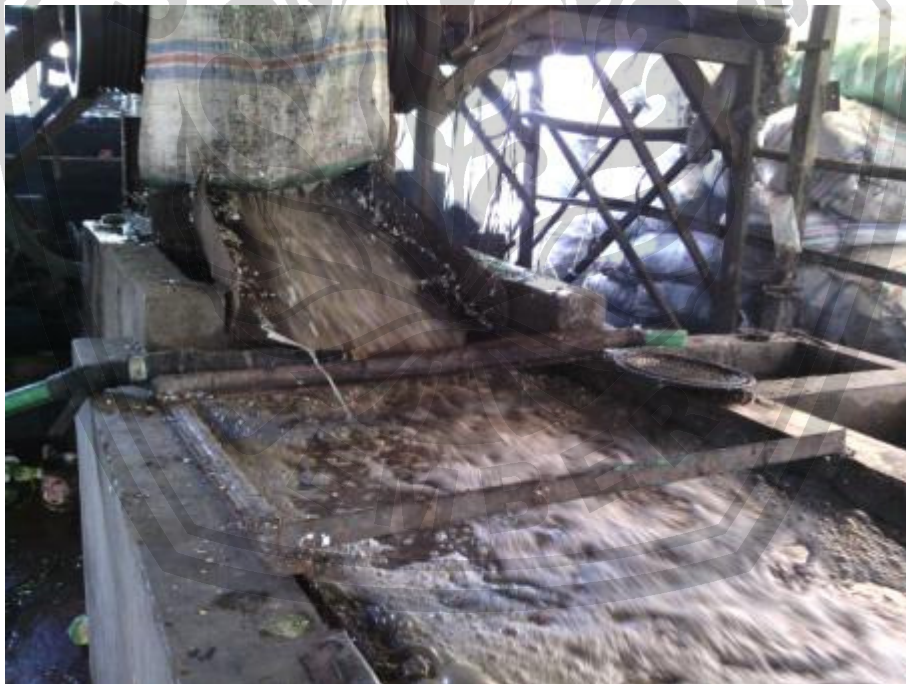
Gambar 8. Observasi proses penghancuran sampah plastik pada alat penghancur
