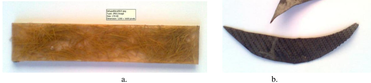
Gambar 2.1 Susunan Penguat Komposit : a. Susunan Acak b. Susunan Silang atau dua arah
