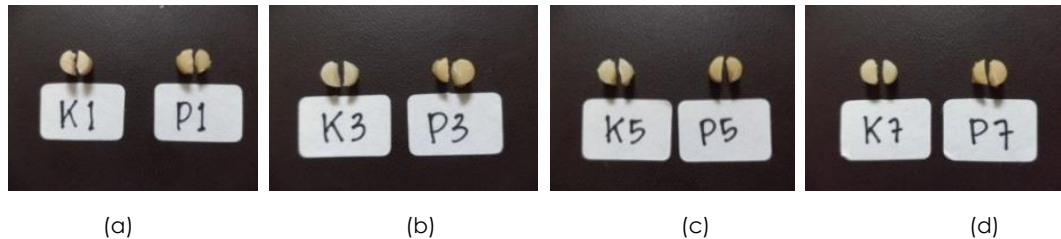
Gambar 4. Hasil pengujian kekuatan tekan sampel resin komposit nanofiller (a) Perendaman hari ke-1; (b) Perendaman hari ke-2; (c) Perendaman hari ke-3; (d) Perendaman hari ke-4
