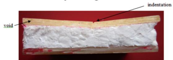
Patahan hasil uji bending fraksi volume 30%
