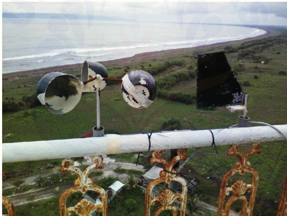
Gambar 3.2 Anemometer berbasis kecepatan angin, arah angin, dan suhu
