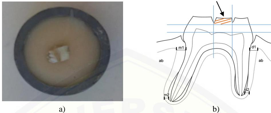
Gambar 3.1 a) Spesimen yang telah ditanam. b) Bagian yang diarsir merupakan bagian yang diuji kekerasannya menggunakan alat *Microhardness Vickers*.
