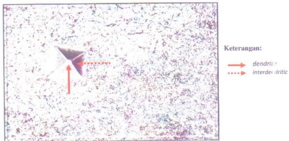
Gambar 3. Indentasi/lekukan hasil uji kekerasan Vickers dengan pembebanan 1000 g, durasi 10 detik (pembesaran 400X)
