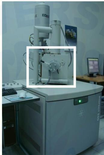
**Gambar 3.18** Sampel dimasukkan kedalam *specimen chamber* (kotak putih)
