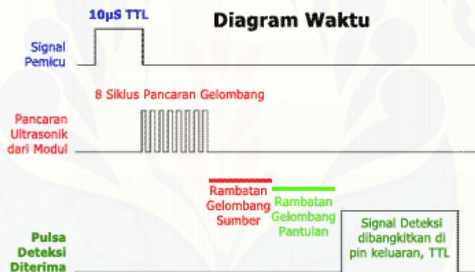
Gambar 2.3 Diagram Waktu Sensor HC-SR04
