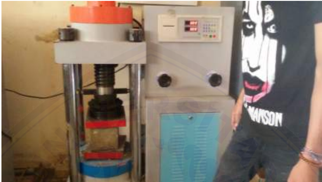
Proses Pengujian Mutu Beton K175
