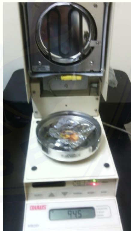
Pengukuran kadar air buah tomat menggunakan moisture meter
