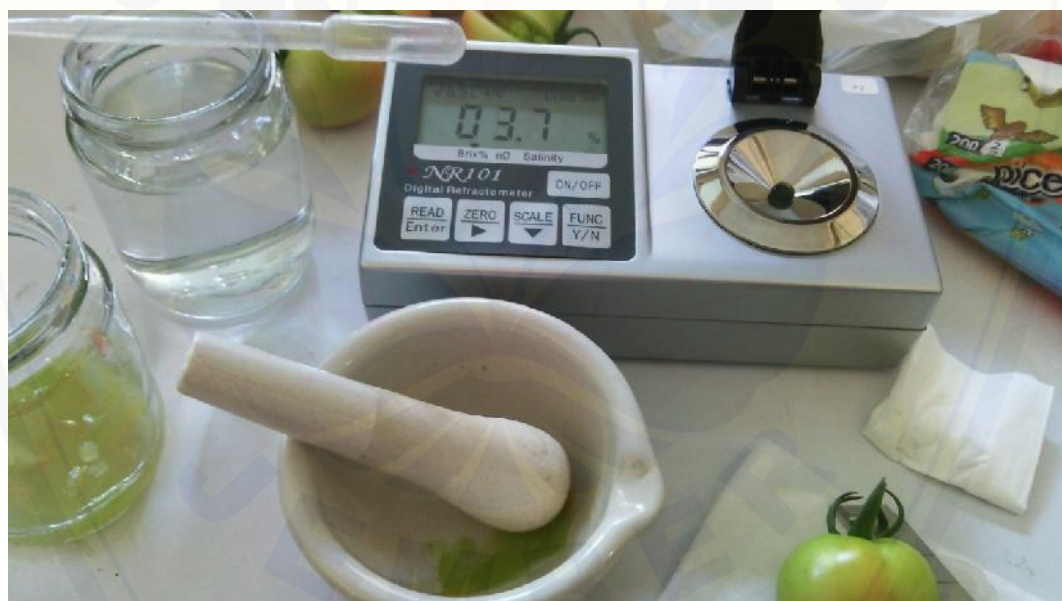
Analisa total padatan terlarut menggunakan digital refractometer
