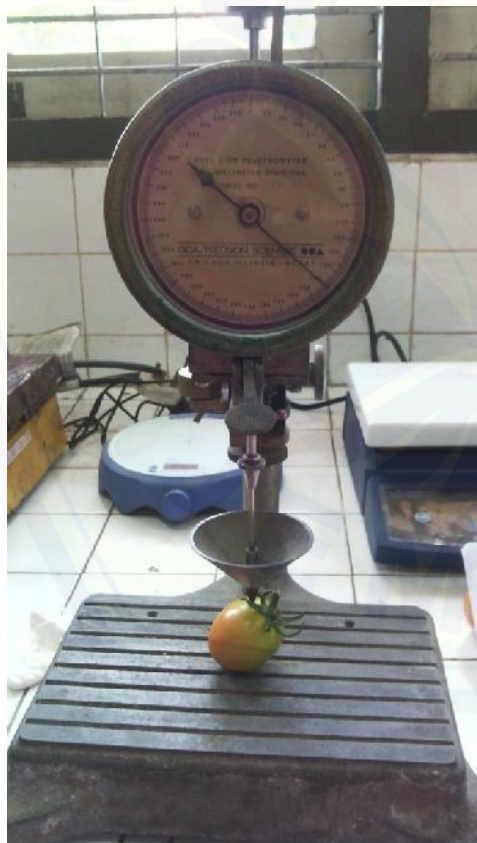
Pengukuran kekerasan buah menggunakan penetrometer
