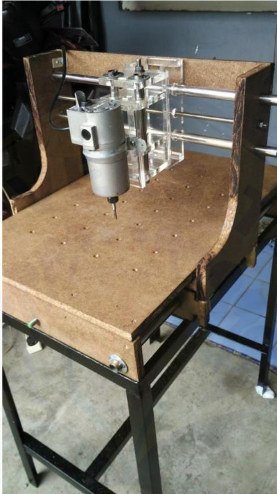
Gambar C.10 Mesin CNC Router Milling tampak sudut
