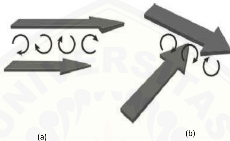
(a) Wind shear terhadap ketinggian (b) Wind shear disebabkan arah angin.
