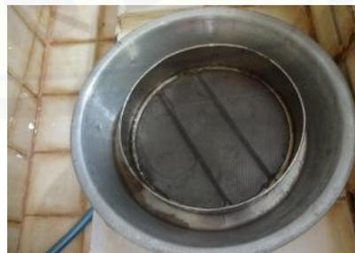
Gambar 6. Saringan untuk menyaring nematoda saat ekstrasi
