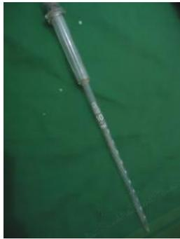
Gambar 13. Pipet sebagai alat untuk mengambil hasil ekstraksi untuk proses perhitungan nematoda
