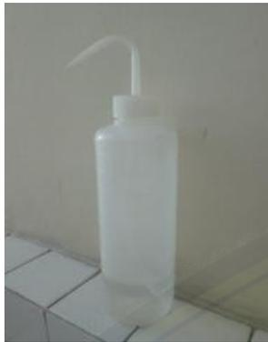
Gambar 19. Botol semprot untuk membersihkan *beaker glass* saat proses penghitungan nematoda
