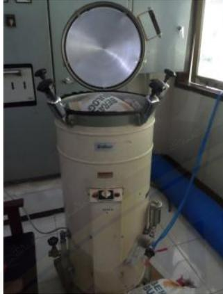
Gambar 1. Autoclave untuk sterilisasi media tanam (tanah)
