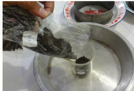
Gambar 16. Menuangkan tanah pada *beaker glass* 100 ml hingga penuh
