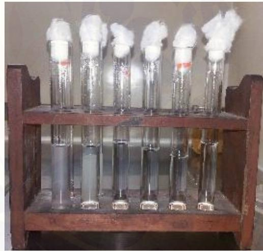
Gambar 22. Rak dan Tabung Reaksi digunakan dalam proses pengenceran bakteri
