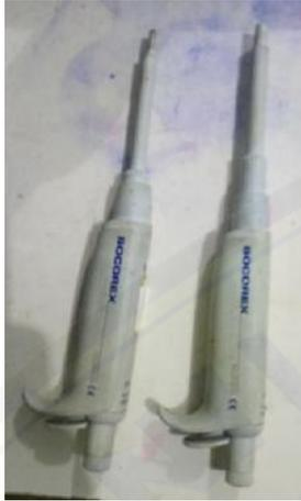
Gambar H.7 Mikropipet
