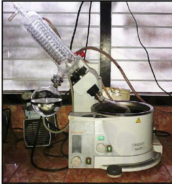
Proses pemekatan ekstrak dengan rotary evaporator
