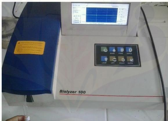
**I.15 Pengukuran Kadar Asam Urat Menggunakan Fotometer**
