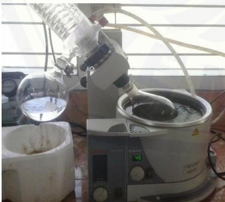
**I.5 Proses Pemekatan Ekstrak Menggunakan *Rotary Rotavapor***
