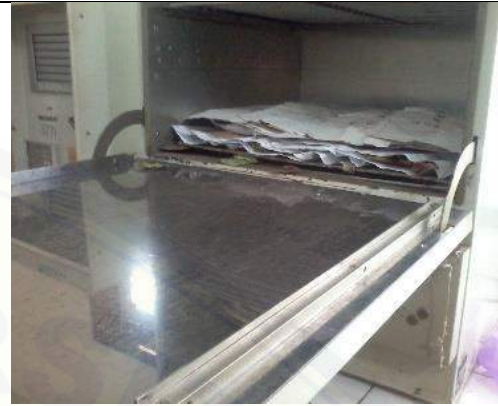
Gambar 8. Oven digunakan untuk mengeringkan tajuk untuk menghitung berat kering
