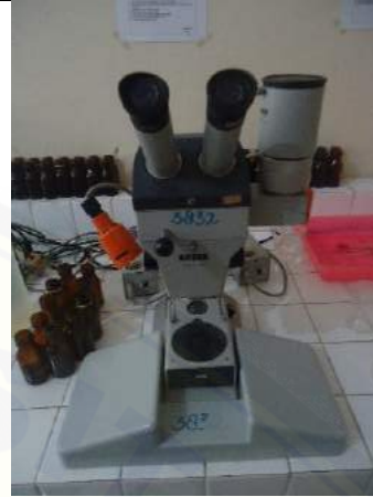
Gambar 14. Mikroskop Binokuler digunakan untuk melihat nematoda
