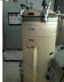
Gambar 2. Autoclave digunakan untuk sterilisasi media tanam
