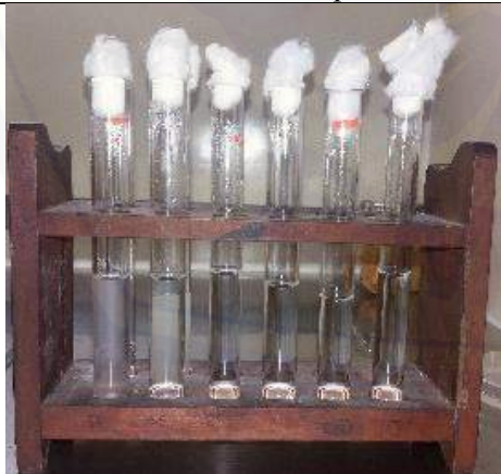
Gambar 11. Rak dan Tabung Reaksi digunakan dalam proses pengenceran bakteri
