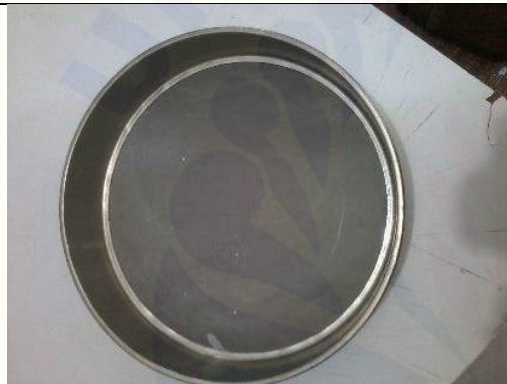
Gambar 9. Saringan Nematoda digunakan untuk menyaring suspensi ekstrak akar maupun tanah
