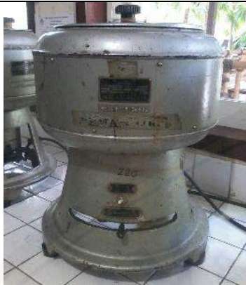
Gambar 7. Setrifuge berfungsi untuk memisahkan suspensi hasil ekstraksi akar
