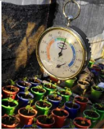
Gambar 13. Termohigrometer digunakan untuk mengetahui suhu dan kelembapan greenhouse
