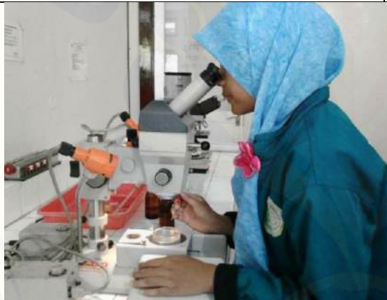
Gambar 33. Menghitung populasi nematoda akar maupun tanah menggunakan mikroskop binokuler
