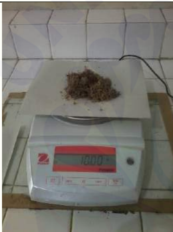
Gambar 3. Timbangan analitik digunakan untuk menimbang akar maupun tajuk
