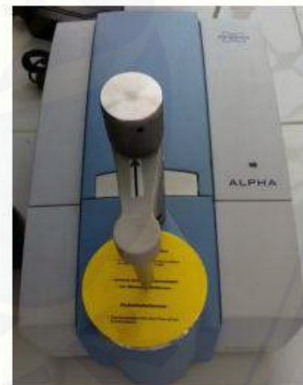
Analisis pembentukan kompleks Hollow Microspheres Fourier Transform Infrared (FTIR)
