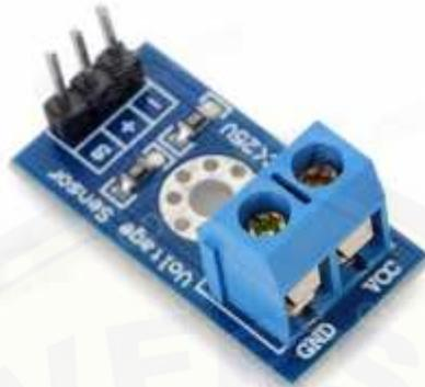
Gambar 2.11 Modul Sensor Tegangan
