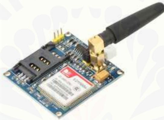
Gambar 2.6 Bentuk Fisik Modul GSM SIM900A
