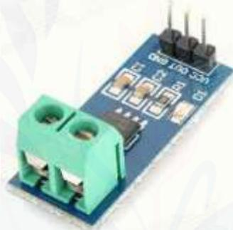
Gambar 2.10 Bentuk Fisik Modul Sensor arus ACS712
