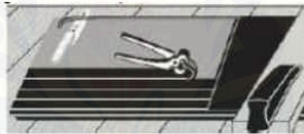
Gambar 3.7 Pengangkatan ply (Sumber: Summa Learning Center )
