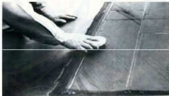
Gambar 3.12 Pembersihan belt dari kotoran (Sumber: Summa Learning Center )
