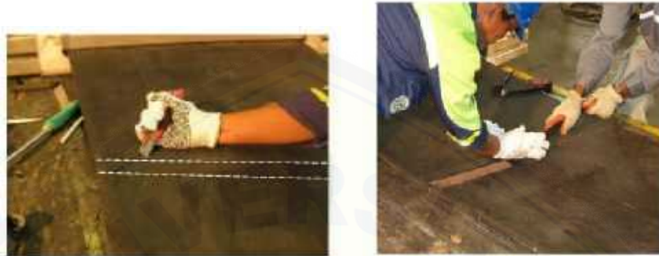
Gambar 3.6 Pemotongan ply pada bagian tengah (Sumber: Summa Learning Center )
