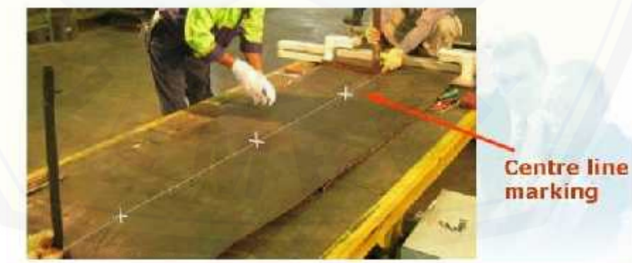
Gambar 3.3 Pembuatan center line (Sumber: Summa Learning Center )
