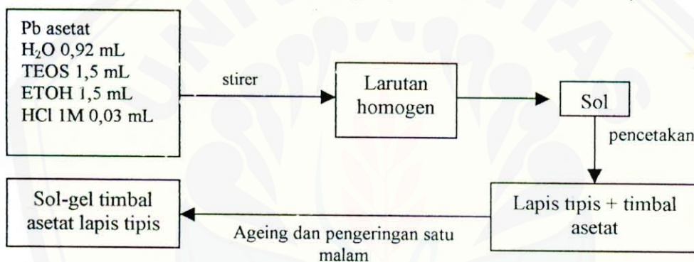
Gambar-8. Diagram Alir Imobilisasi Timbal Asetat Pada Sol-Gel (Kuswandi, B and Narayanaswamy, 1999)
