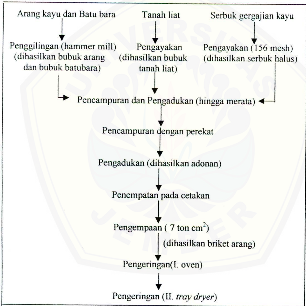
Gambar 3.1: Diagram alir proses pembuatan briket arang
