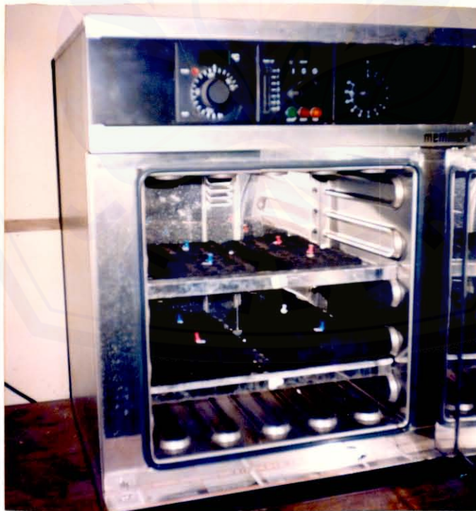
7.4 Foto proses pengeringan briket arang dengan oven
