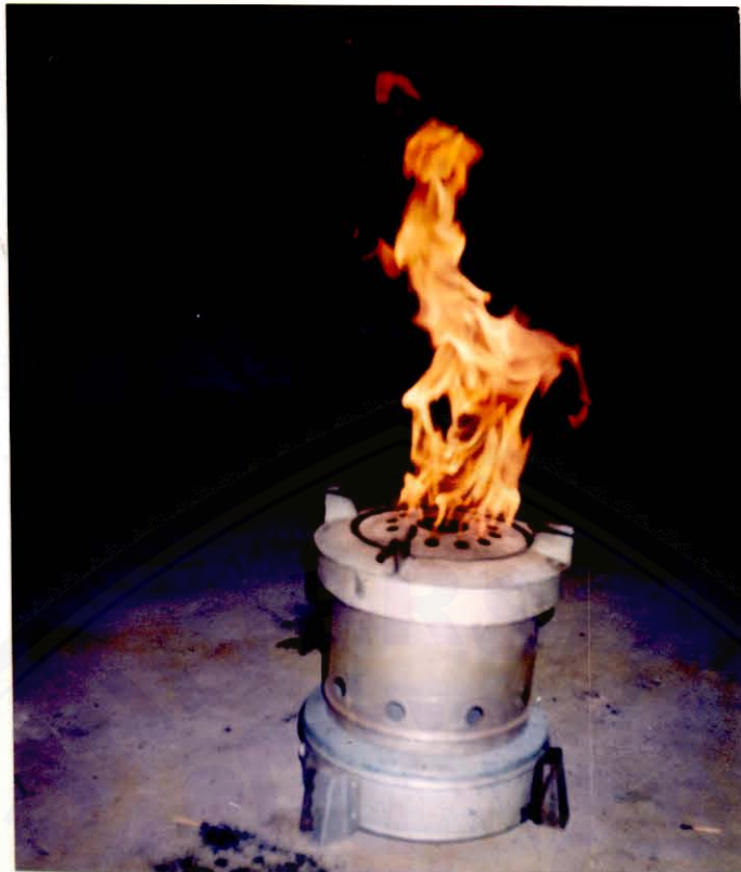
7.5 Foto pengujian briket arang pada penyalaan awal setelah perendaman
