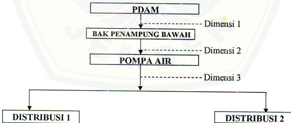
Gambar 3.1 Skema Aliran Distribusi Air Bersih
