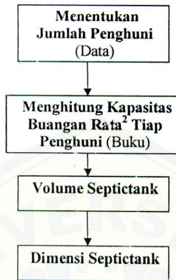
Gambar 3.7 Skema Untuk Menentukan Dimensi Septictank
