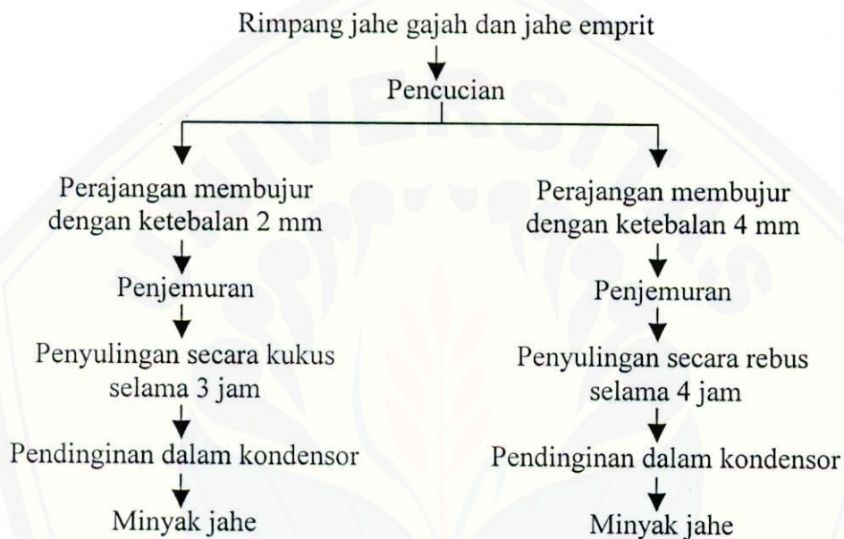
Gambar 1. Diagram Alir Penyulingan Minyak Jahe
