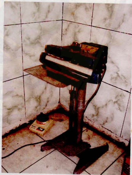
Alat bantu dalam proses pengemasan berupa timbangan (gambar kiri) dan penutup kemasan plastik (gambar kanan)
