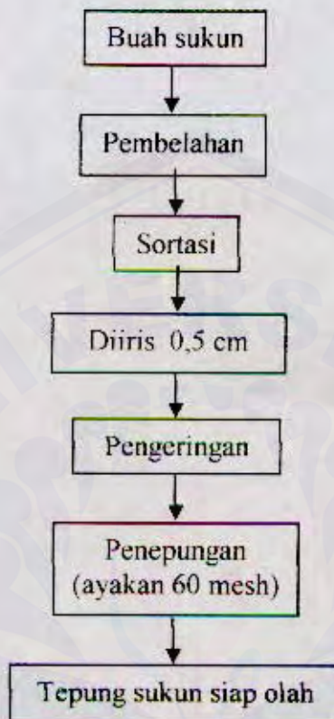
Gambar 2. Diagram Alir Pembuatan Tepung Sukun
