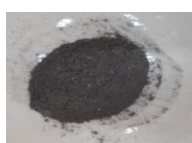
Gambar 4. Silikon hasil metalotermis dari fly ash batubara
