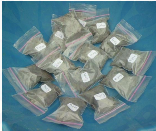
Gambar 3.6 Sampel Tanah Untuk Pengukuran Kadar Air
